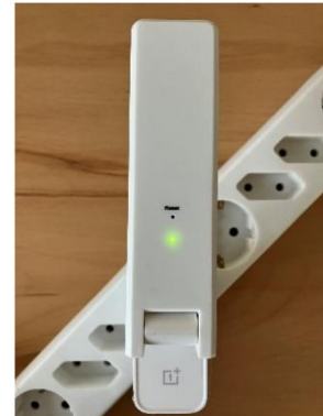
Nach etwa 3-10 Minuten hat sich die DTU mit den Netzwerk verbunden und leuchtet Grün
