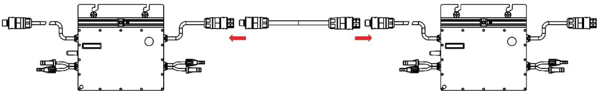
A) Installieren Sie die AC-Endkappe am offenen AC-Anschluss des letzten Mikrowechselrichters des Wechselstromkreises.
