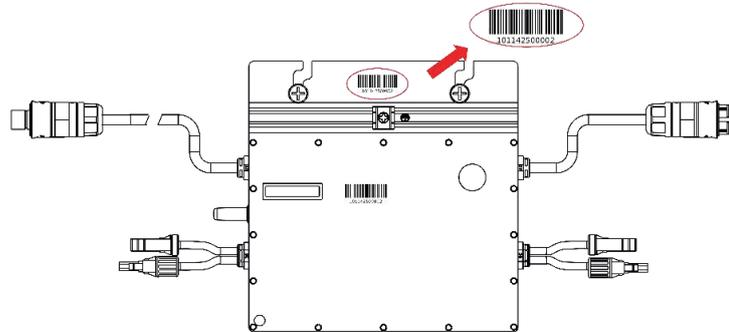
B) Bringen Sie das Seriennummertikett an der dementsprechenden Stelle in der Installationskizze an.
