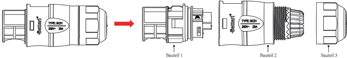
2. Führen Sie das AC-Kabel durch Bauteil 3 und Bauteil 2 und vervollständigen Sie die Verdrahtung von L, N und Erdung im Bauteil 1 des AC-Anschlusses wie im Bild unten dargestellt:
