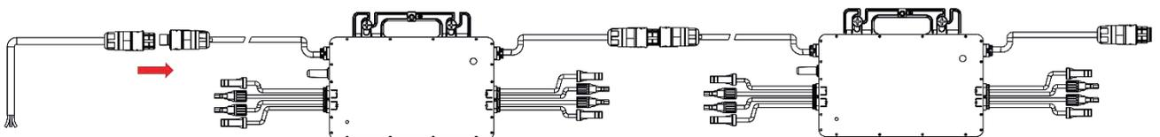
C) Schließen Sie die andere Seite des AC-Endkabels an den Verteilerkasten an und verbinden Sie es mit der hausinternen Installation.
